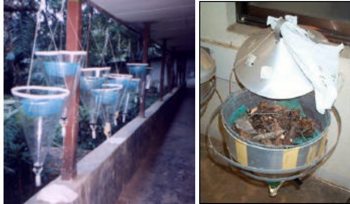
Gambar : Modifikasi Corong Berlese untuk keperluan di lapangan dan Corong Berlese dari aluminium yang digunakan di laboratorium (Foto: C. Rahmadi)
